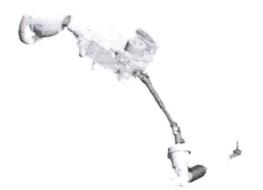
O funcionamento da **direção elétrica** independe do motor e dispensa todas as correias que fazem a bomba de óleo funcionar, comum nos carros com direção hidráulica.
