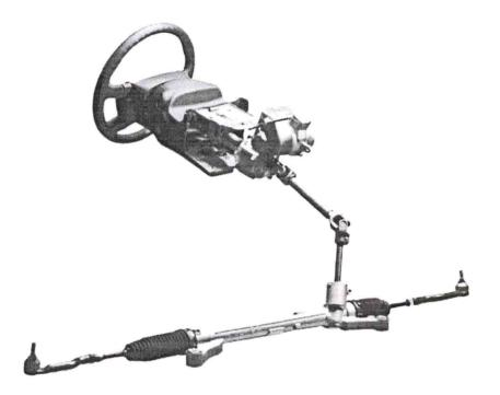
Quanto à direção hidráulica, o principal objetivo dessa direção é facilitar a condução do veículo, permitindo ao motorista uma redução na força aplicada sobre o volante, que passa a comandar a parte mecânica com maior facilidade, pois o maior trabalho é feito hidraulicamente.
